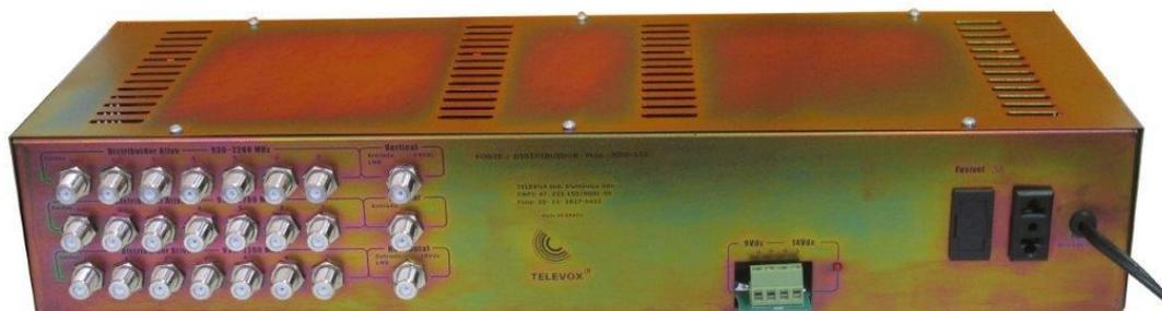
O módulo MFD- 16 (Módulo Fonte e Distribuidor) tem como finalidade fornecer as tensões necessárias e distribuir os sinais dos LNB's para os Receptores/Decodificadores.
